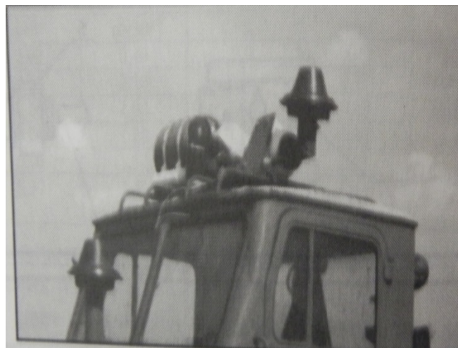
Рисунок 2.15.5 – Крышный вариант компоновки ФВУ на тракторе Т4-А
