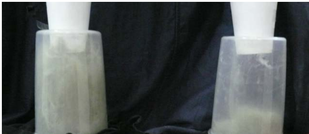
Рис. 2.19.1 Зависимость скорости местного отсоса за счет изменения диаметра воздуховода
