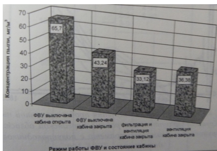
Рисунок 2.15.7 – Влияние режима работы ФВУ и состояния кабины на концентрацию пыли
